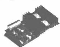
**AMPLIFICATORE** finale 50 Watt RMS - segnale ingresso 250 mV - distorsione 0,3% alla massima potenza - rapporto S/N migliore di 70 dB - alimentazione 40/50 V. - dimensioni 190 x 100 x 36.
