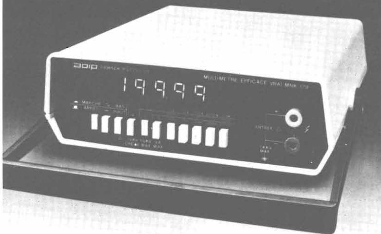
*Il Multimetro digitale MNK 179, realizzato su licenza Keithley, è in grado di effettuare misure di resistenza, tensione (continua e alternata) e corrente. L'apparecchio dispone di cinque display a LED dell'altezza di 13 mm. Tra le altre caratteristiche sono da segnalare l'ottima risoluzione (10  $\mu$ V) e la precisione ( $\pm 0,04\%$ ).*
