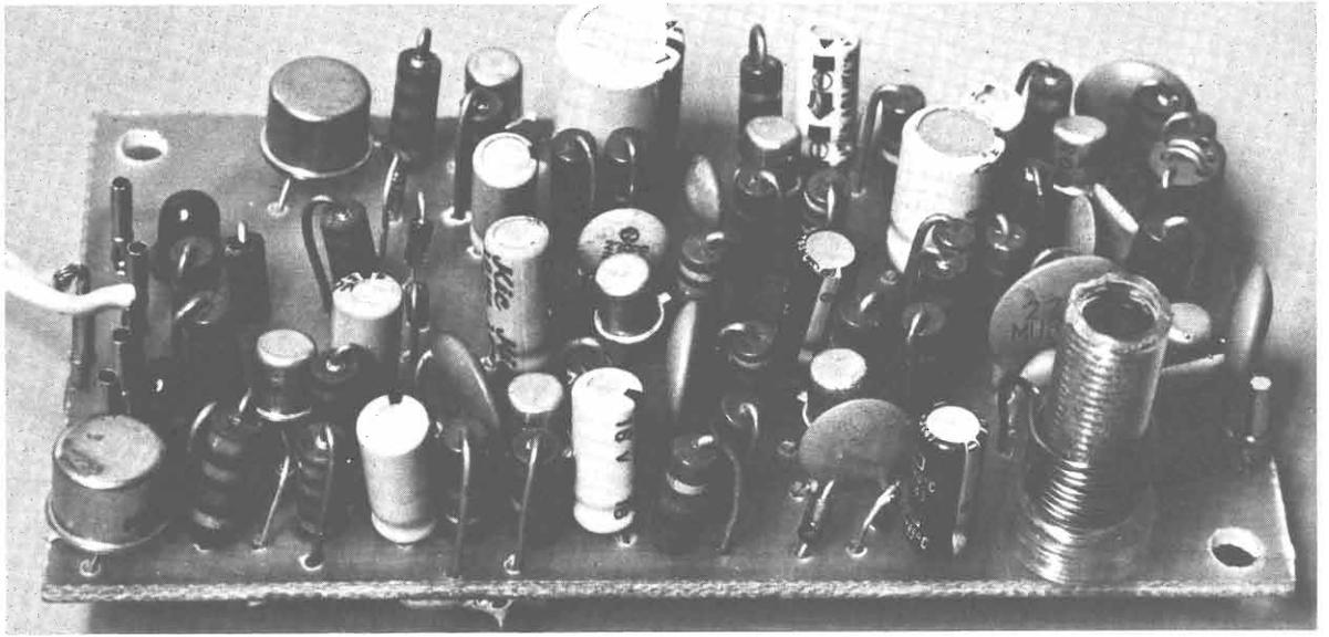
*Ecco come appaiono ricevitore e trasmettitore a montaggio ultimato. Il ricevitore può essere ospitato a bordo di un modellino come accade per l'auto radiocomandata della ELRE che vedete fotografata accanto al nostro RX.*
